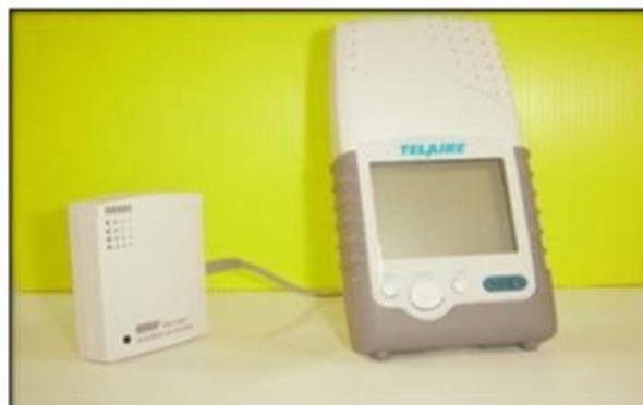
Figura 23 - *Telaire 7001* - Sensor automático para medir CO<sub>2</sub> com HOBO Logger U12 013
