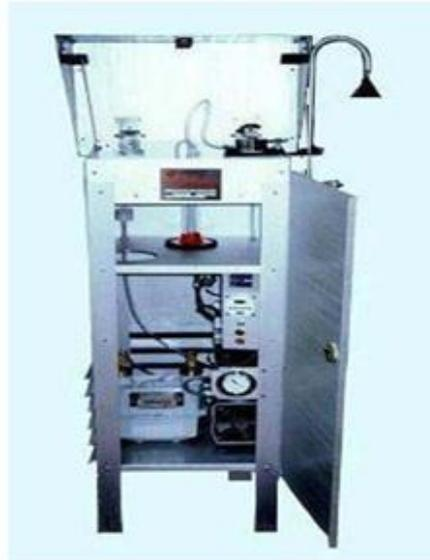
Figura 15 - Amostrador de Pequeno Volume (APV) para medida simultânea de  $\text{SO}_2$  e Fumaça Preta.
