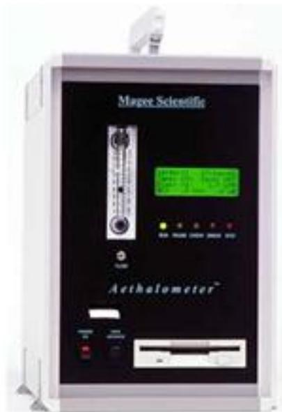
Figura 20 – Aetalômetro – medidor de Fumaça preta (*black carbon*) pertencente ao LAPAt (IAG – USP)
