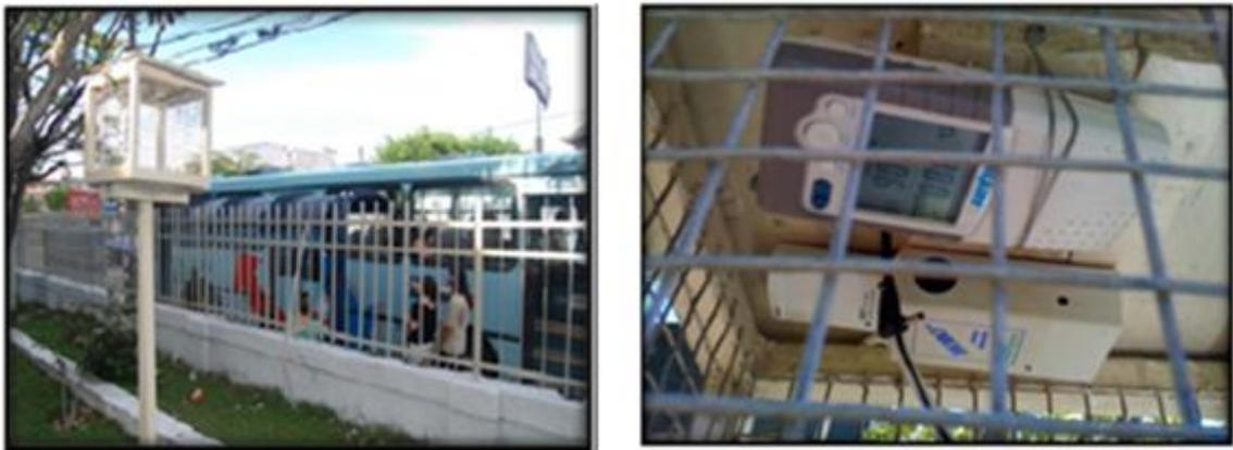
Figura 21 - Visão externa e interna da miniestação de CO e CO<sub>2</sub> LERCA - IFCE
