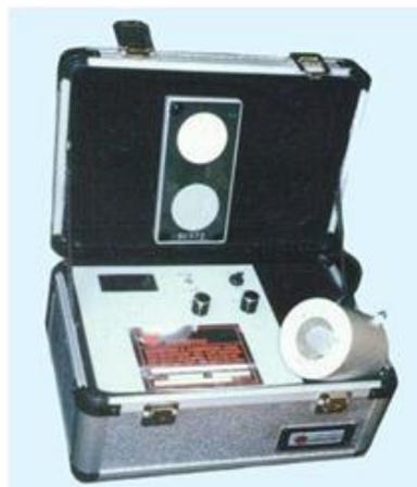
Figura 16 - Analisador da refletância da luz em filtros para a determinação da concentração de Fumaça Preta
